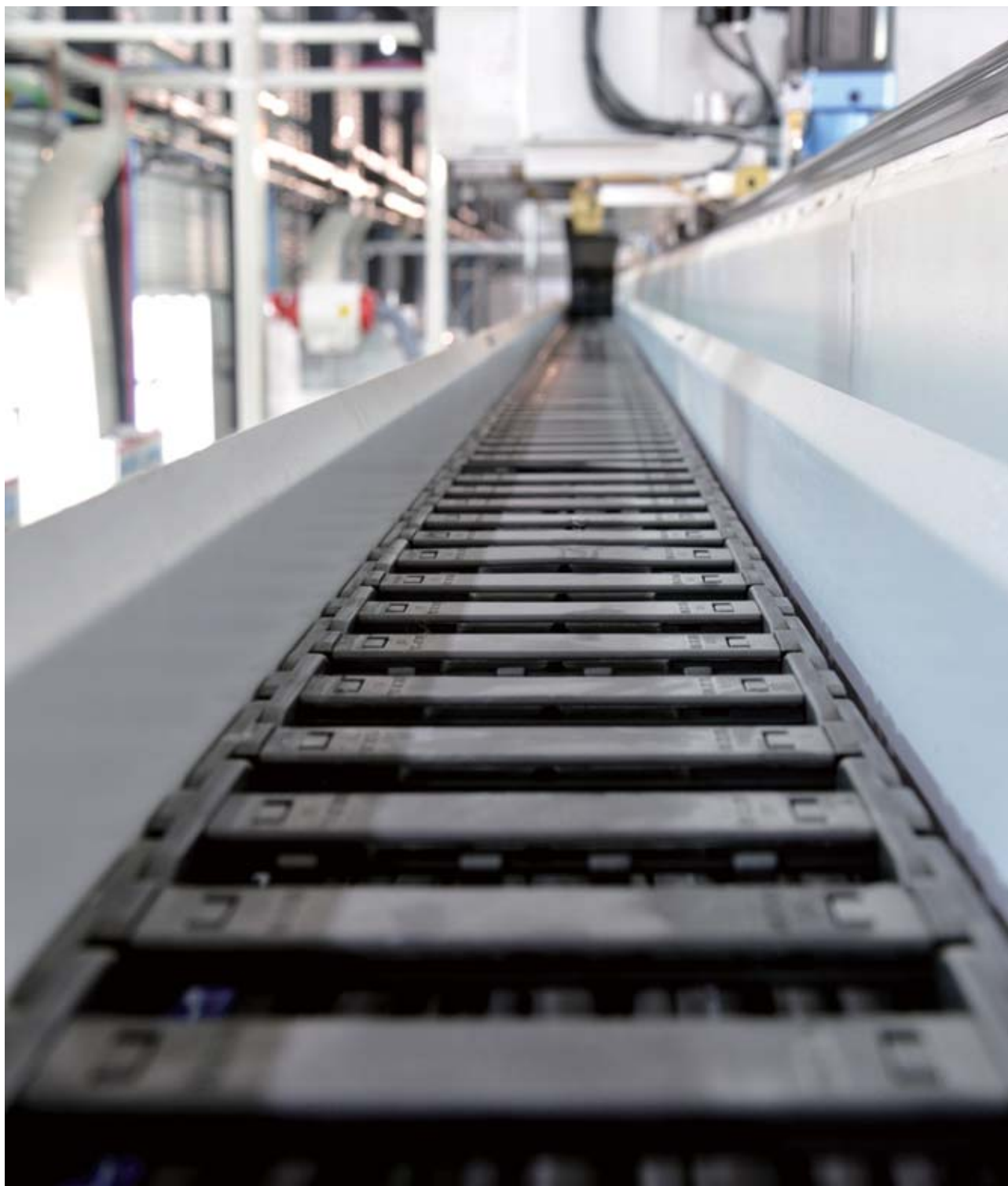
C03电缆拖链用于保护长行程机器人电缆 C03 cable chains protect long-stroke robot cables
